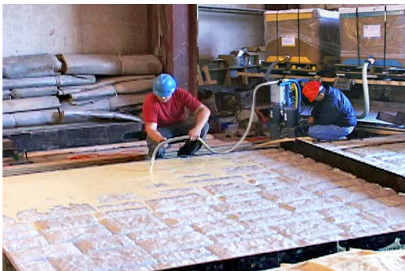
1 El caucho VytaFlex® 60 es vaciado utilizando la máquina EZ MIX®.
