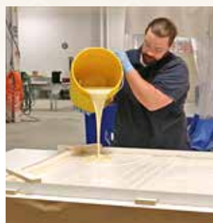
3 Se dispensa, mezcla y vacía VytaFlex® 60 sobre el modelo original.
