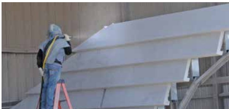
8 Se le da el acabado deseado utilizando el método de chorro de arena.
