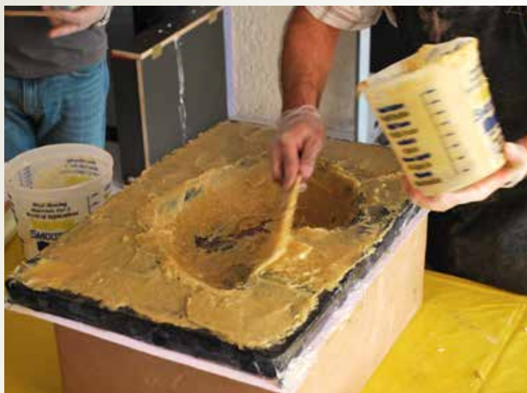
3 Se utiliza el plástico de uretano Plasti-Paste® II para crear la primera mitad del contramolde.
