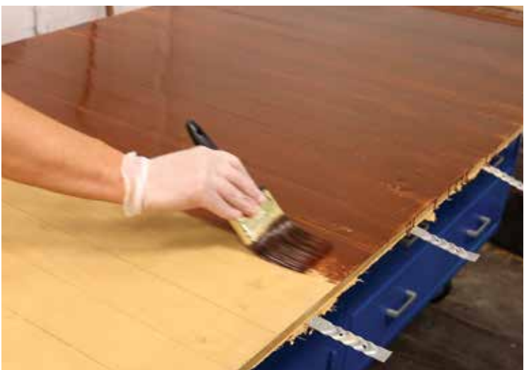
9 Se utilizan tintes para dar el acabado a los paneles y luego se aplica sellador.
