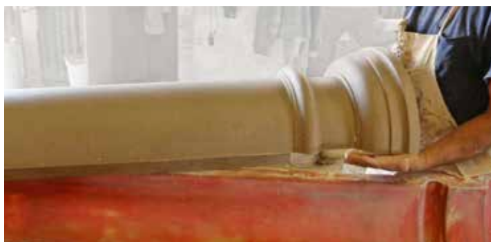
6 La columna terminada está lista para ser instalada en el interior, o puede ser sellada para aplicaciones en el exterior.
