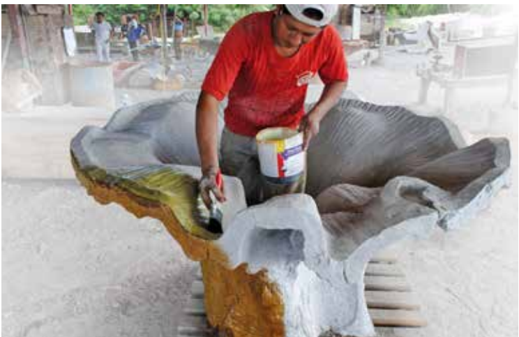
8 El proceso de teñido da al vaciado de GRC la apariencia de ser madera real.
