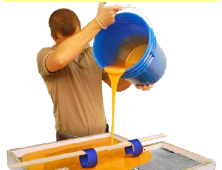
4 Se vacía el cacuho y se incrustan correas para manejar el molde.
