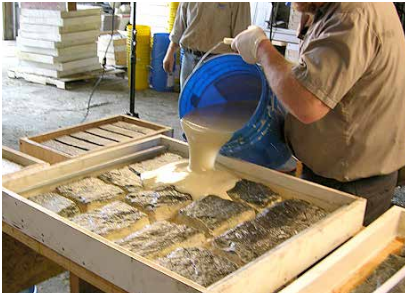
1 VytaFlex® 60 es mezclado y vaciado en la caja del molde.
