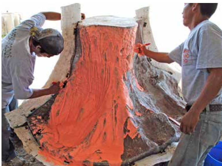
3 Se crea el molde en 2 partes, cada una consiste de 4 capas aplicadas a brocha.
