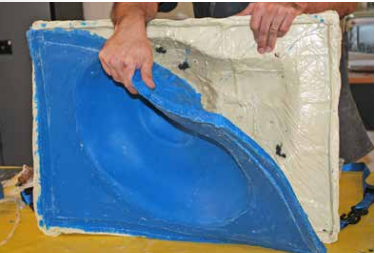
5 Mold Star® 30 endurece en seis horas, luego se vacía la otra mitad del molde.
