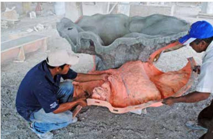
7 Se remueve el vaciado terminado en GRC del molde de Rebound®25.
