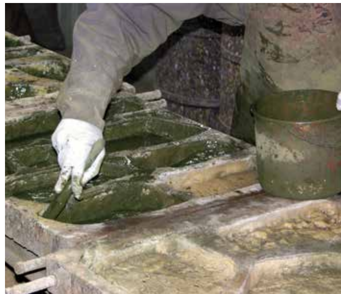
2 Se aplica pigmento en la cavidad del molde para alcanzar el color deseado.
