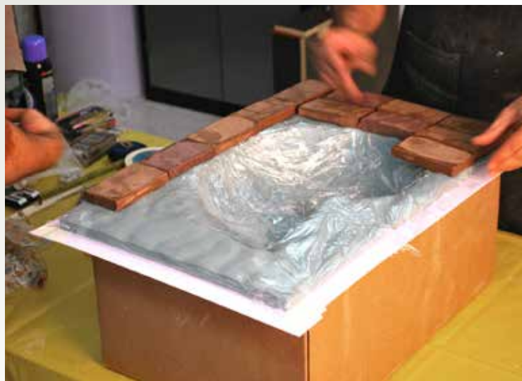
2 Se aplica la técnica de molde de cavidad. Debe utilizarse arcilla libre de azufre para crear el espacio de la cavidad.
