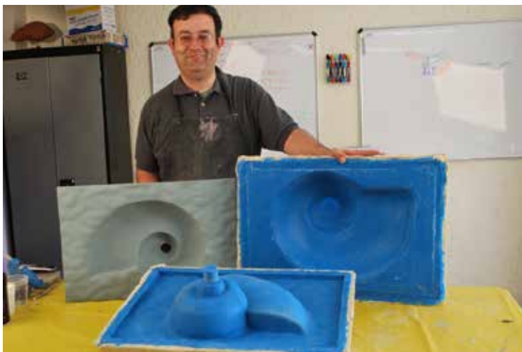
6 Mold Star® 30 captura los detalles perfectamente y está listo para el concreto.
