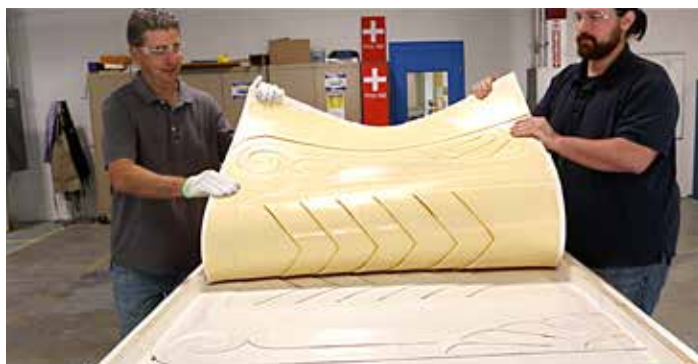
4 Después de endurecer por 16 horas, el tapete de VytaFlex® 60 es desmoldado.
