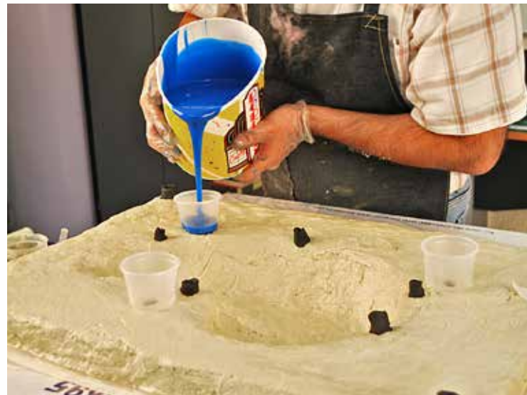
4 La silicona Mold Star® 30 es mezclada y vaciada en la cavidad del molde.
