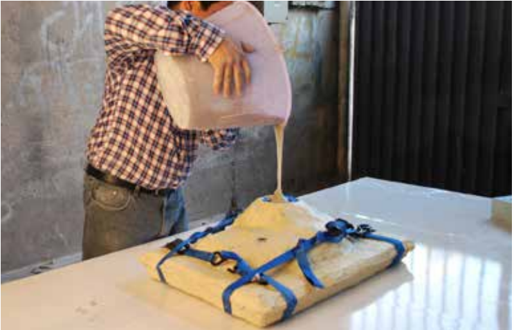
7 Se vacía el concreto polimérico de baja viscosidad en la cavidad del molde.
