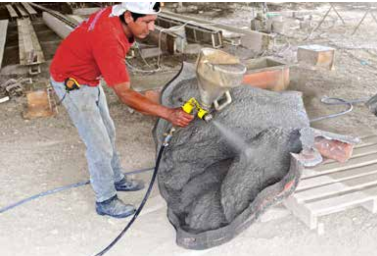
5 Se rocía GRC en ambas partes del molde, luego se juntan.
