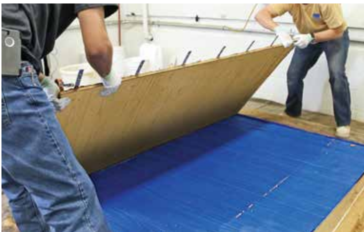
8 Se producen cuatro paneles de diferentes tamaños en el mismo molde.
