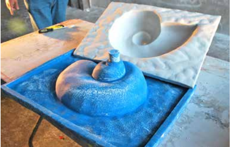
8 Después de 6 horas, el nuevo lavabo es instalado y el molde de Mold Star® 30 está listo para vaciar nuevamente.
