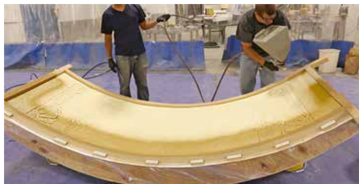
5 Se rocía la capa superficial de GRC utilizando una pistola de tolva.
